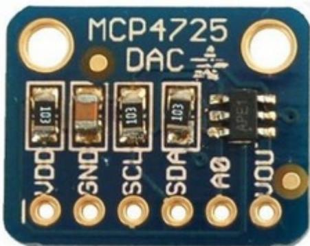
Convertisseur Digital/Analogique pour Microcontrôleur, interface I2C, 12 bits
