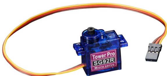
08RI05 – Exemple de servo-moteur
