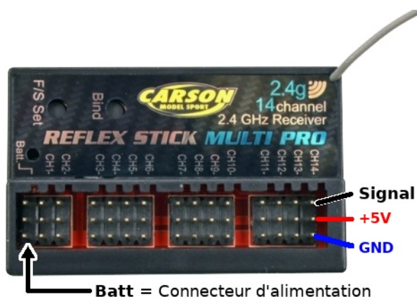
08RI04 – Module récepteur RC
