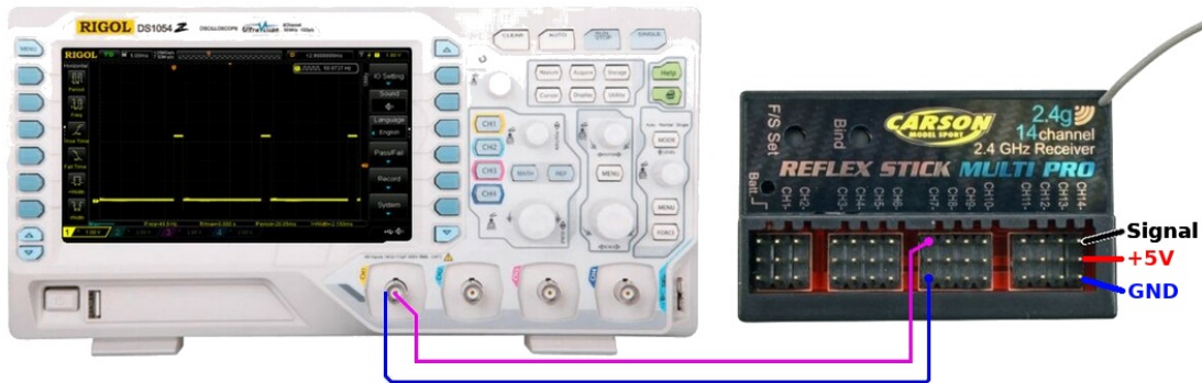
08RI06 – Mesure du signal réceptionné.
